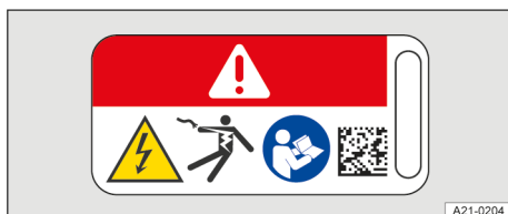
Fig. 5 Plaquette d'avertissement sur les composants haute tension
